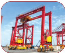
起重机 Cầu RTG (40T)
