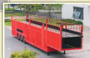
三轴汽车运输笼式半挂车 (可装载8辆车)
