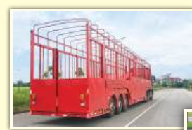
三轴汽车运输笼式半挂车 (可装载6辆车)
