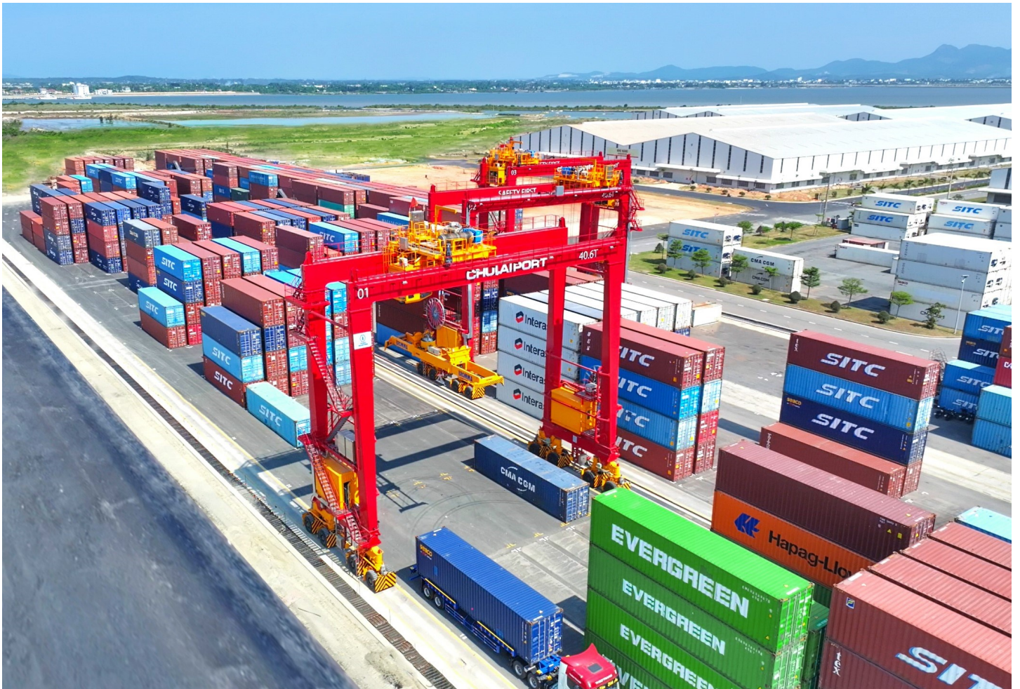
3 cầu khung RTG do THACO INDUSTRIES sản xuất có sức nâng 40 tấn
