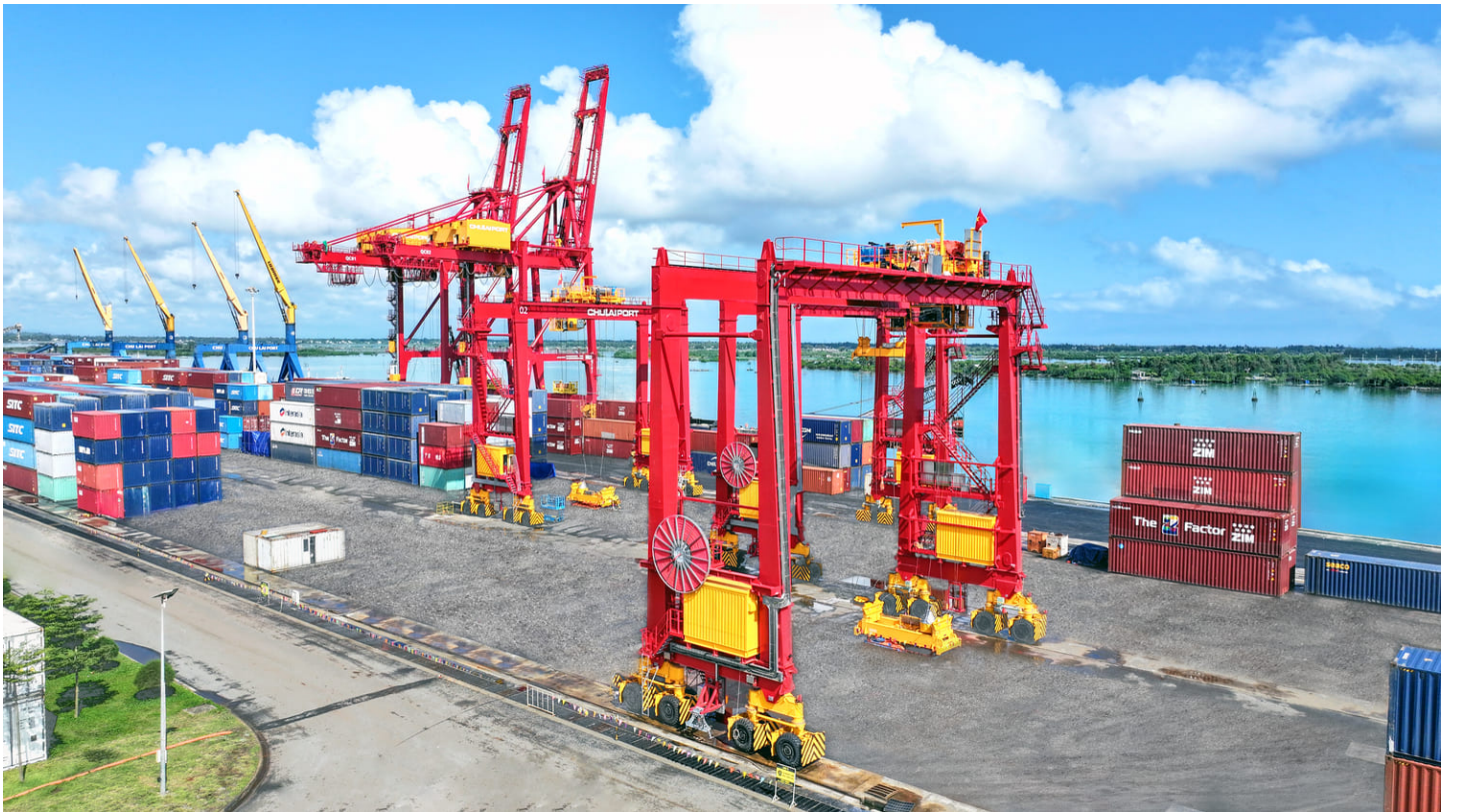
Hình 4: Hệ thống cầu STS có tổng công suất 60 lượt nâng hạ/giờ, năng suất và sản lượng xếp dỡ gấp ba lần so với trước đây.
