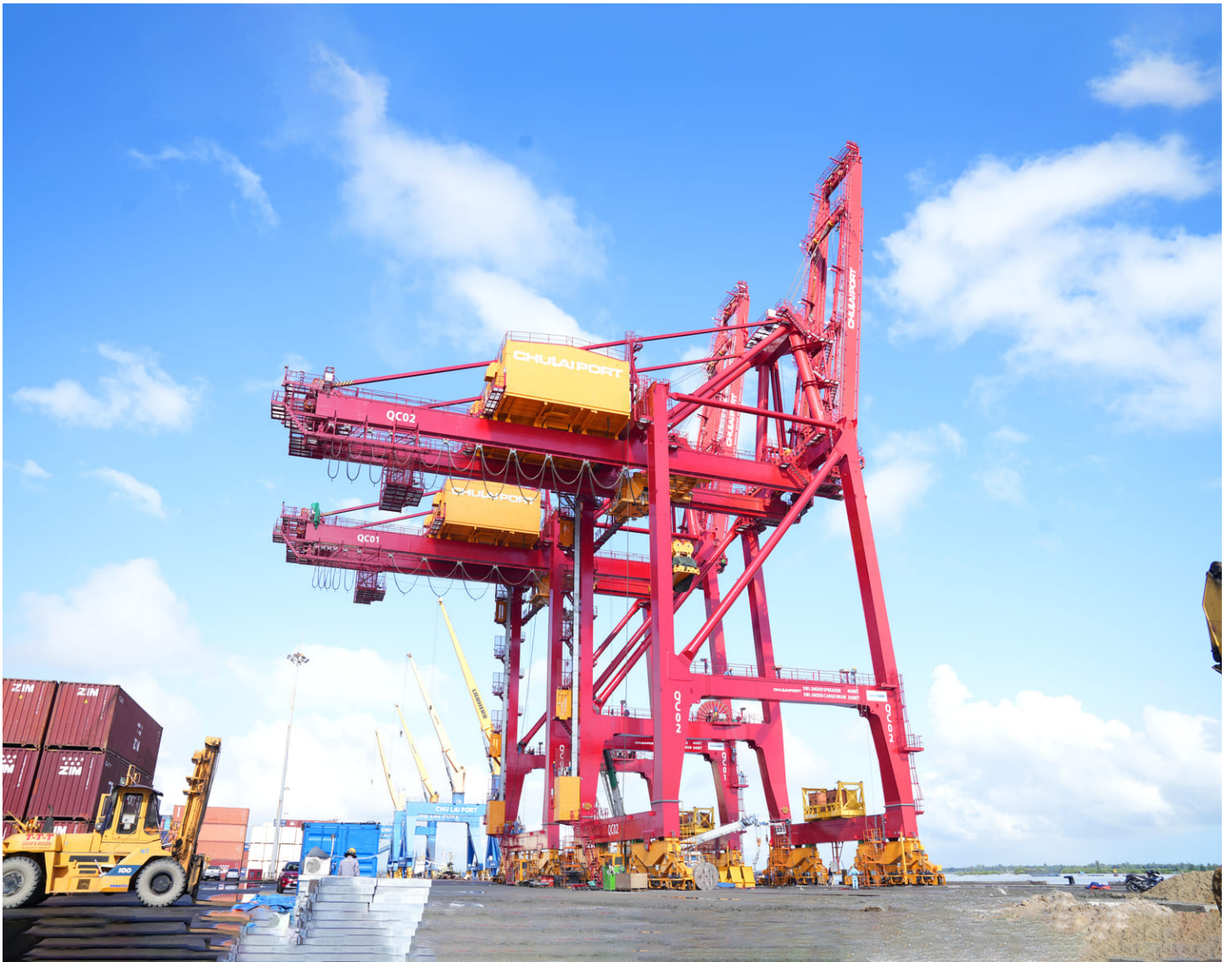
Hình 2: Cầu STS có khả năng bốc dỡ các container trọng tải 40 tấn, tầm với 40m (từ cầu ra tàu), phù hợp với các tàu container 50.000 DWT.
