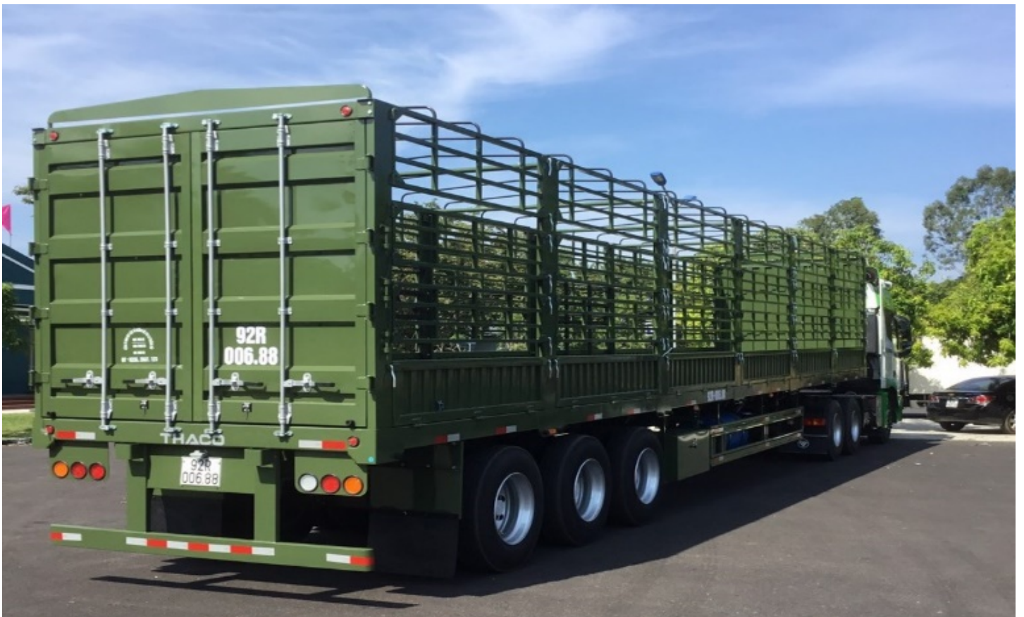
Thùng xe dài 14,6 m, có khả năng vận chuyển gia súc với số lượng lớn (từ 32-37 con/chuyến). Xe có thiết kế phù hợp, đáp ứng các yêu cầu về tiêu chuẩn xe vận chuyển gia súc chuyên dụng.
