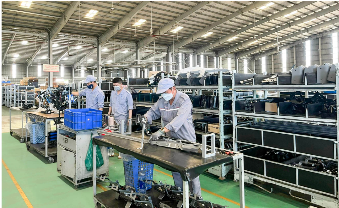
Công nhân đang lắp ráp cụm taplo xe tải tại khu vực tháo kiện, kiểm hàng
