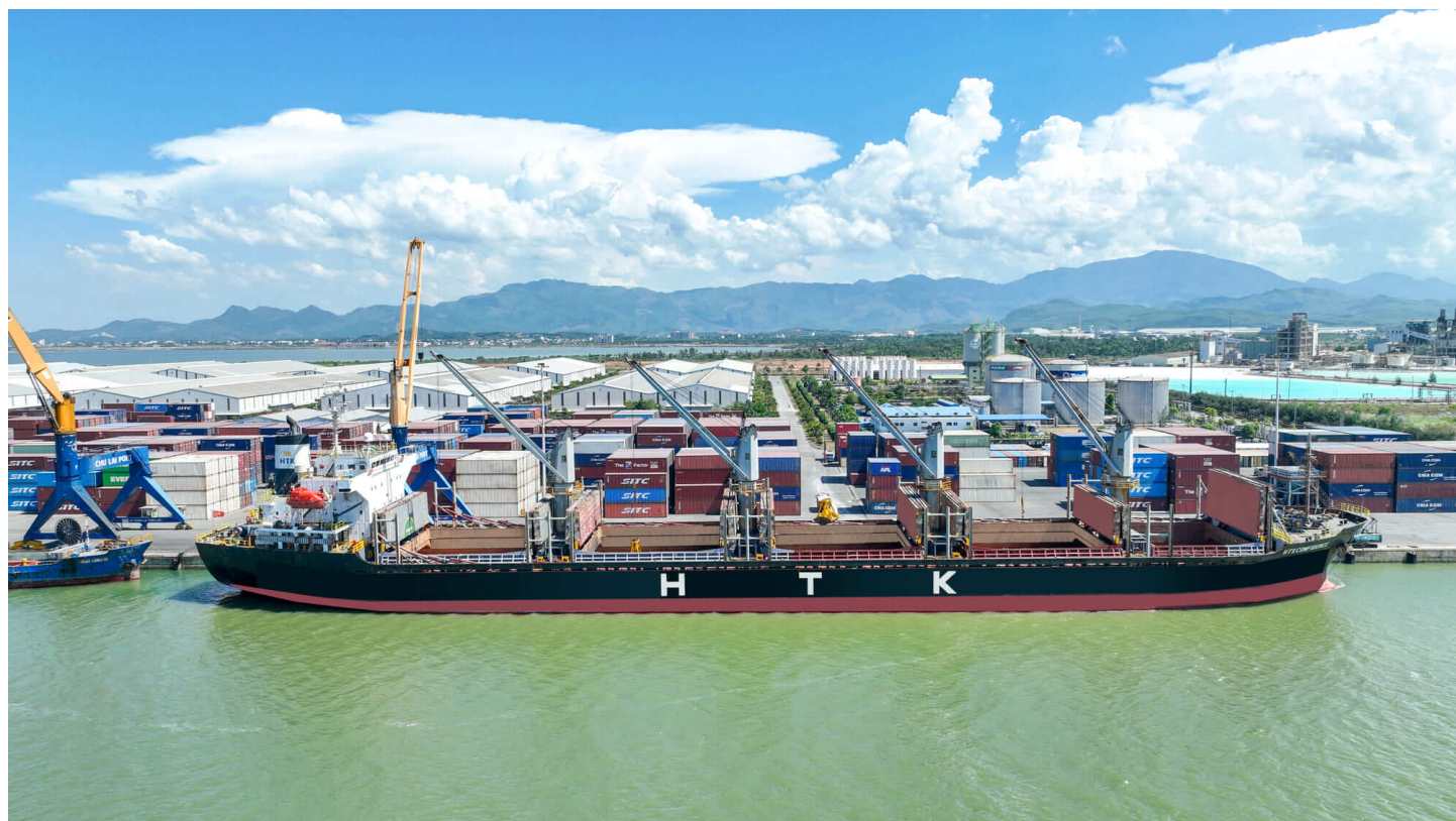
Tàu HTK CONFIDENCE dài 169m, rộng 27m, có tải trọng hơn 28.000 tấn
